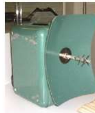
Telurômetro MRA-2 (1956), distanciômetro de ondas radio-eléctricas
