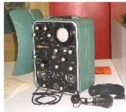
Telurômetro MRA-2 (1956), distanciômetro de ondas radio-eléctricas
